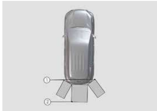
1. Detectado por el sensor de esquina trasero
