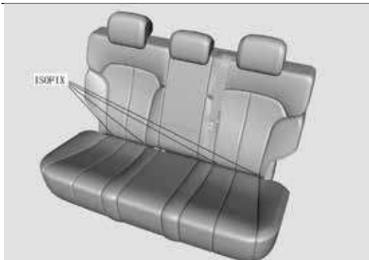
Posición de las etiquetas de punto fijo ISOFIX
